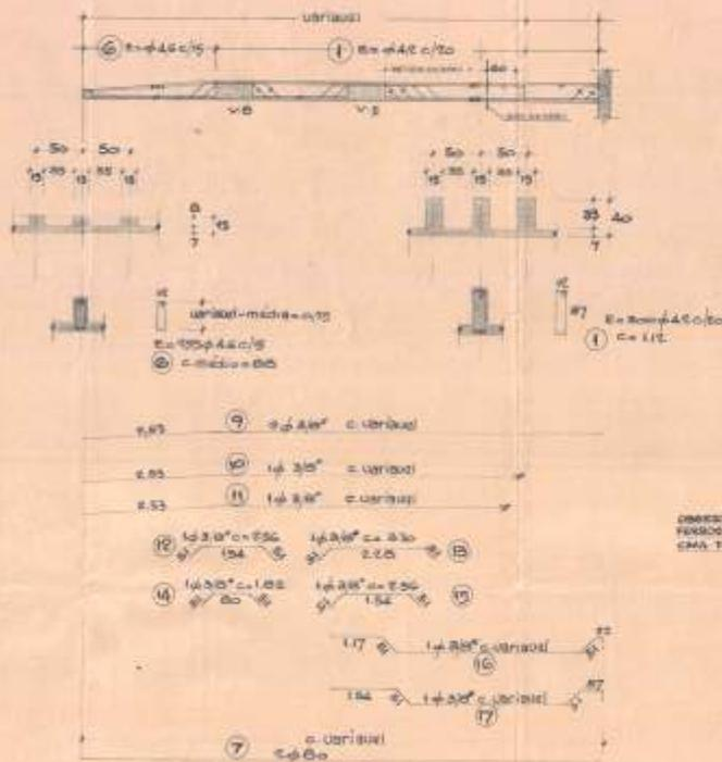
**ARMAÇÃO TIPO DAS LAJES (PALCO) Esc. 1:10 - 1:50**
